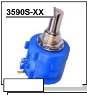
Potenciometro 10 vueltas variable de alambre sencillo 20K - 50K - 100K
